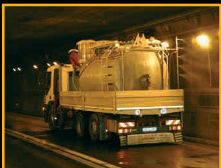
Autocarro con cisterna da 10.000 l per irrorazione detergente.
