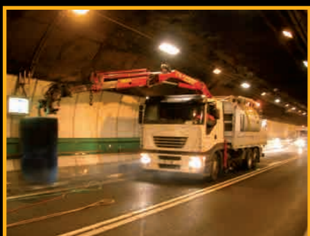
Autocarro con cisterna da 12.000 l per rotolavaggio e successivo risciacquo.
