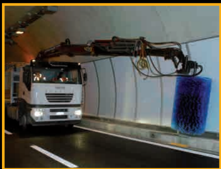
Rotolavaggio di pannelli in alluminio ceramizzato.
