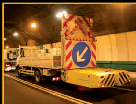
Autocarro omologato con assorbitore d'urti (TMA) e figura 401 Cds luminosa.
